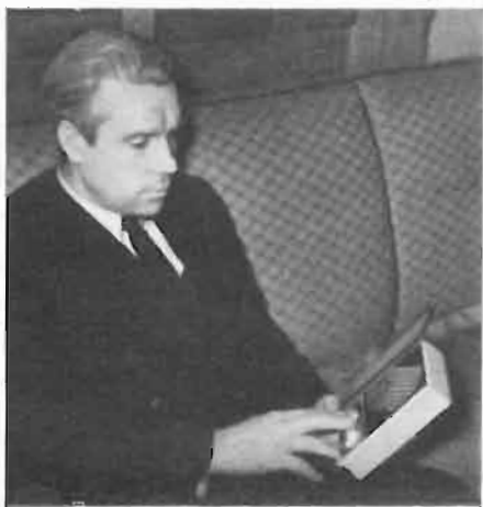
Il minuscolo apparecchio radio che vediamo nelle mani dell'ing. A. Serieghin è realizzato sotto forma di un libro e pesa circa 800 gr. È uno dei primi modelli, apparsi recentemente nell'U.R.S.S. di apparecchi a transistori. Vi sono montati otto transistori P6, alimentati da una batteria a 1,5 V con autonomia di 25 ore. L'antenna è incorporata ed è del tipo a ferrite. (Sovinformburo)
